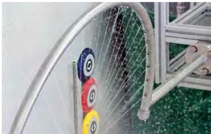
Prüflinge bei einer Spritzwasserprüfung IPX4K mit genormtem Spritzbogen
