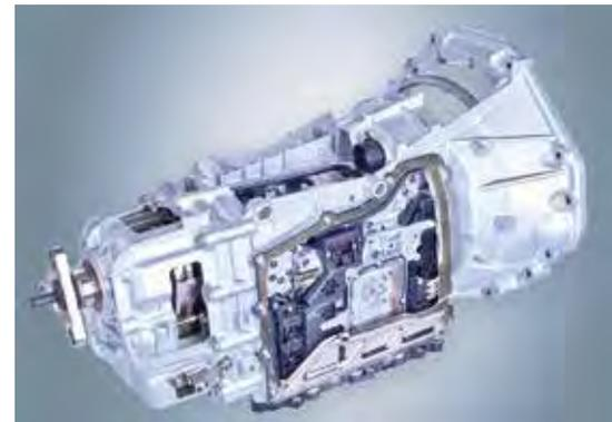
Ansicht des neuen PowerShift-Getriebes S55, innerer Aufbau teilweise sichtbar
